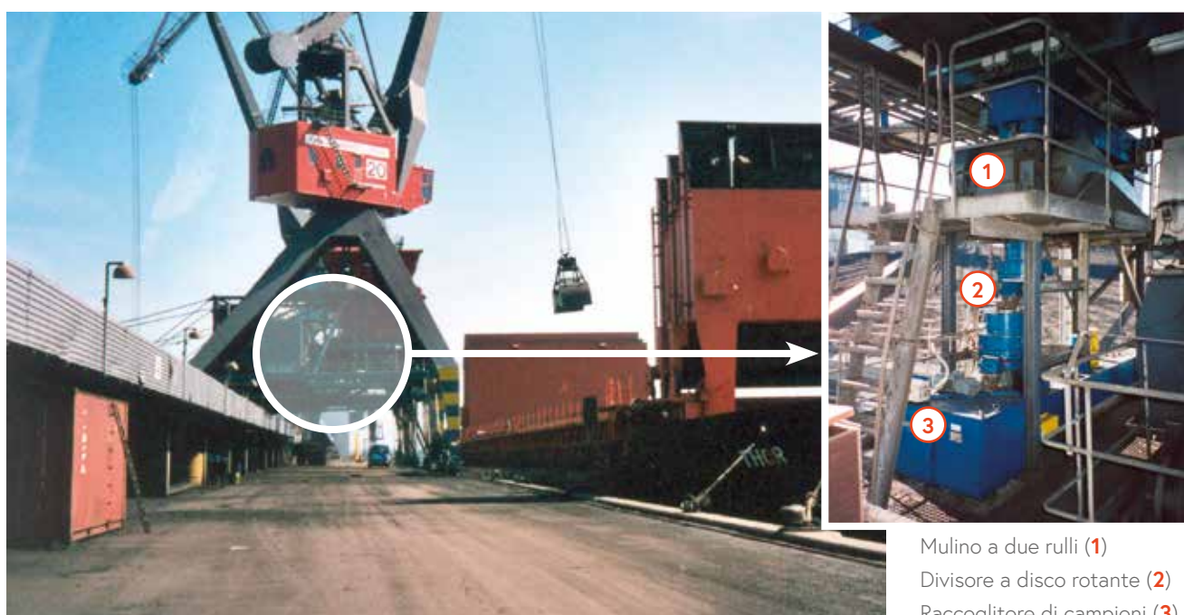
Campionamento del carbone in una gru di scarico
