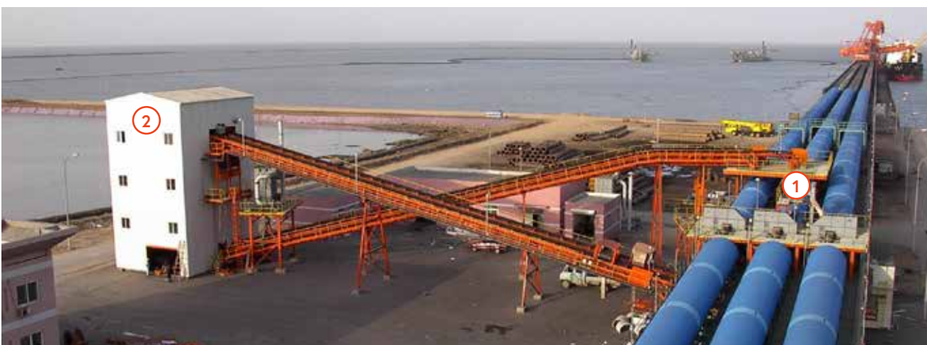
Prelievo del campione (1) e preparazione del campione (2) di carbone durante il caricamento di una nave
