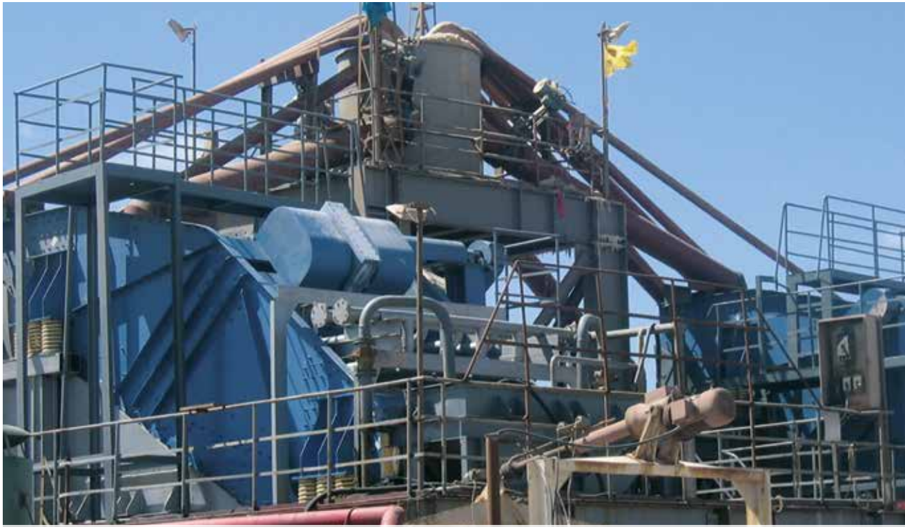
Przesiewacz liniowy typ BHG, przesiewacz bananowy do odsiewu soli potasowej w Chinach
