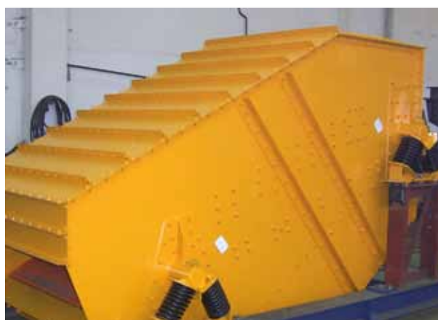
Грохот HR-C с линейными колебаниями для классификации бурового раствора
