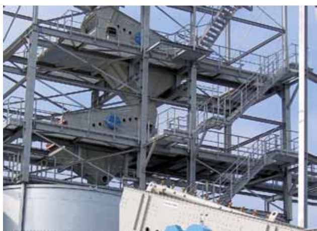
3 грохота REKORD с круговыми колебаниями для классификации песка и гравия на гравийной фабрике
