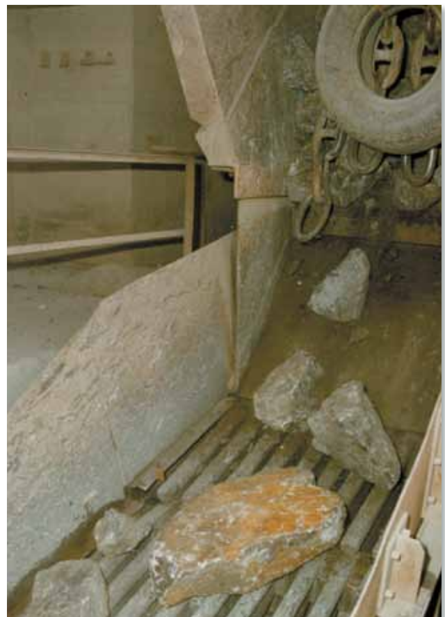
Первичный грохот V16/40 I со ступенчатой колосниковой решёткой для уменьшения нагрузки на дробилку в известняковом карьере
