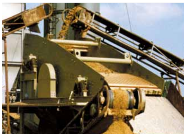
Грохот REKORD с круговыми колебаниями размер 1,6 x 4,0 м, для просеивания влажного песка
