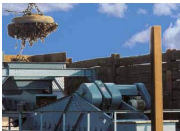
Двойной инерционный грохот HG для сортировки измельченного металлолома
