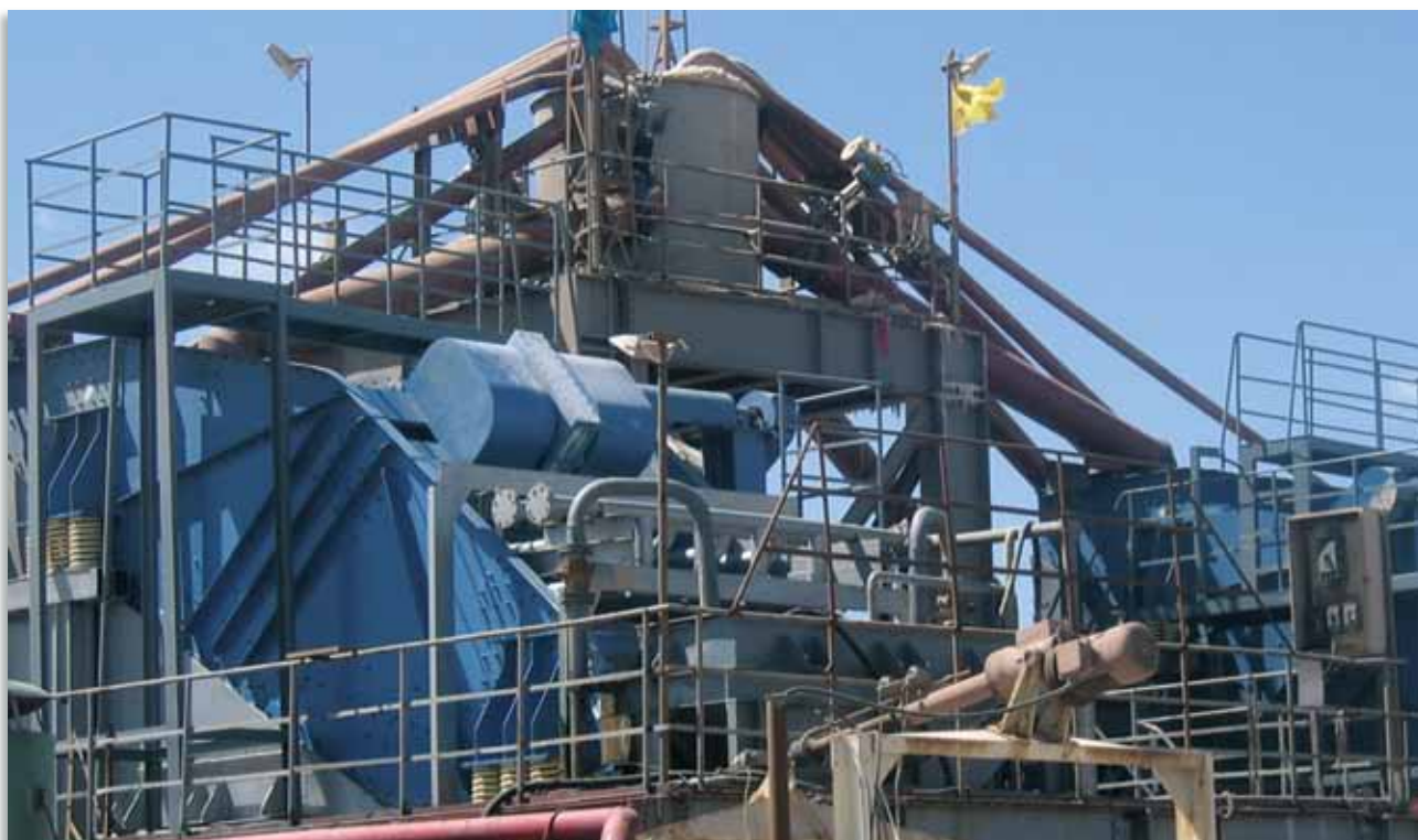
Двойной инерционный грохот «Банан» для обезвоживания на месторождении поташа
