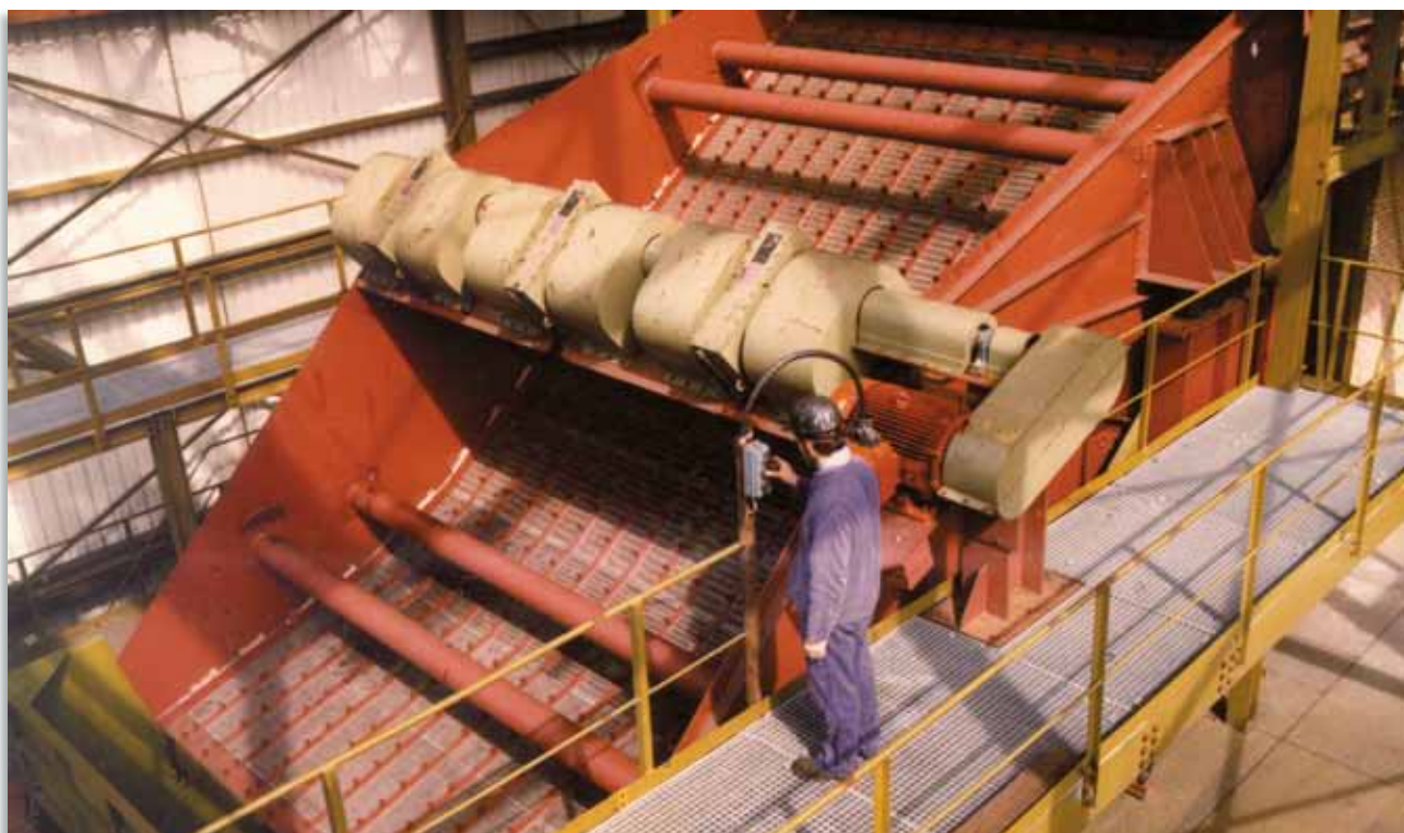
Двойной инерционный грохот типа BHG для предварительного разделения угля
