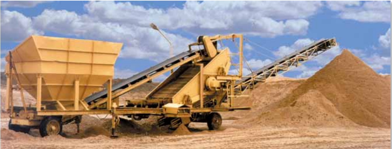
Мобильная просеивающая установка песка, состоящая из просеивающей машины с круговыми колебаниями, приемного бункера, ленточных конвейеров и шасси
