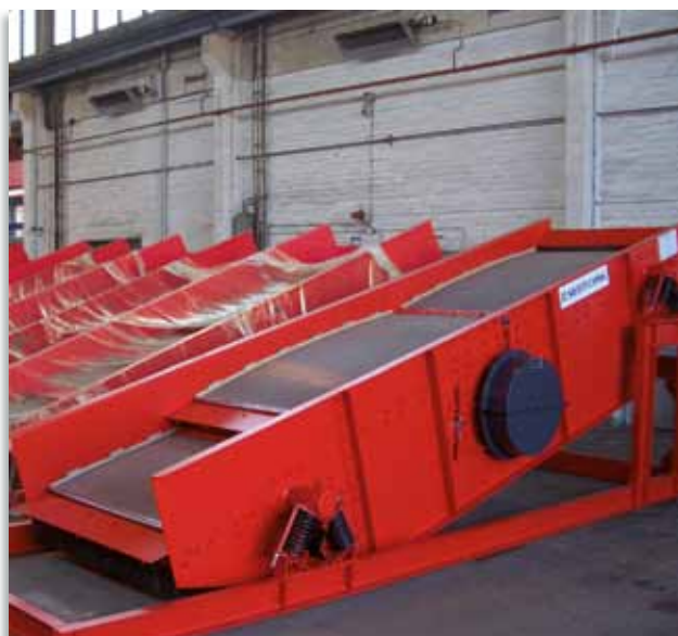
Грохот с круговыми колебаниями Record для просеивания корма для крупного рогатого скота
