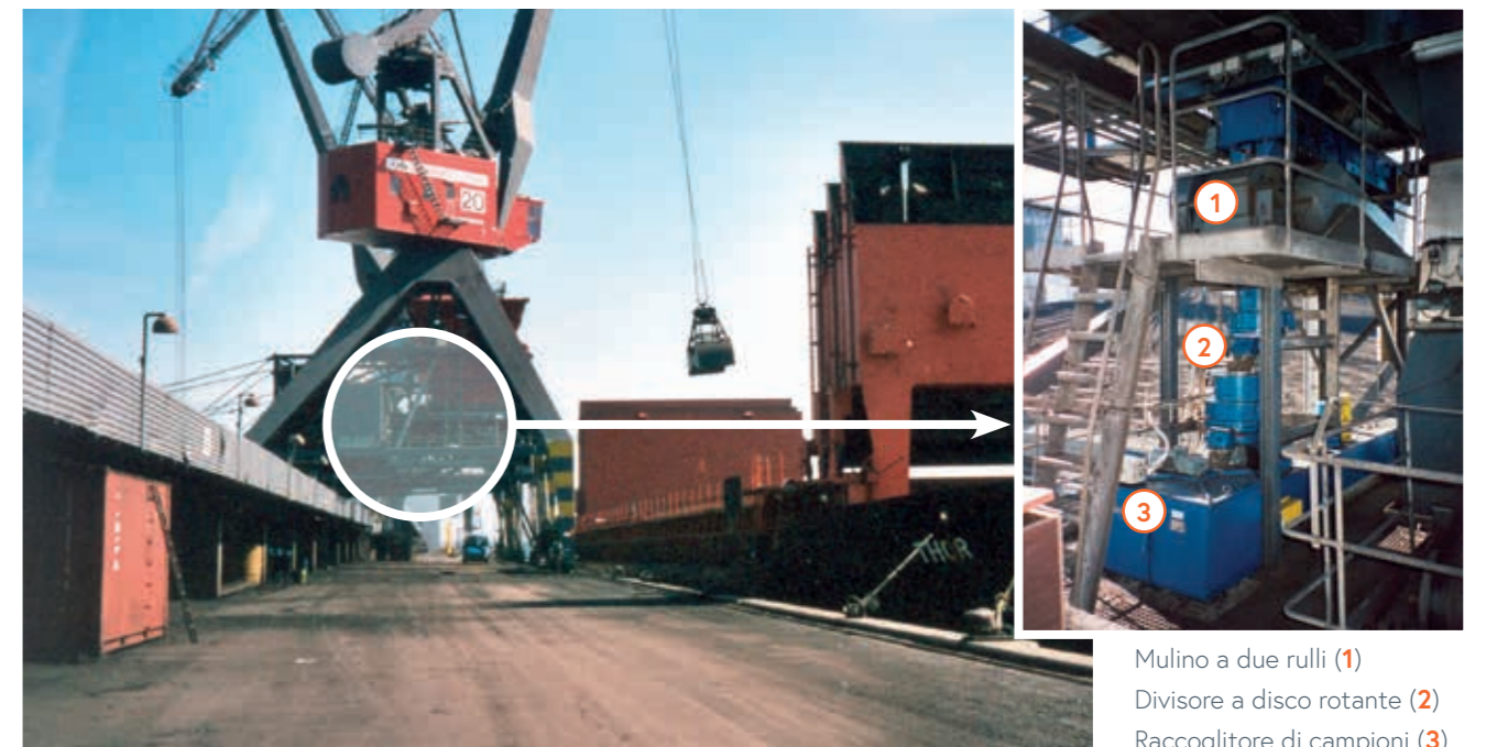
Campionamento del carbone in una gru di scarico
