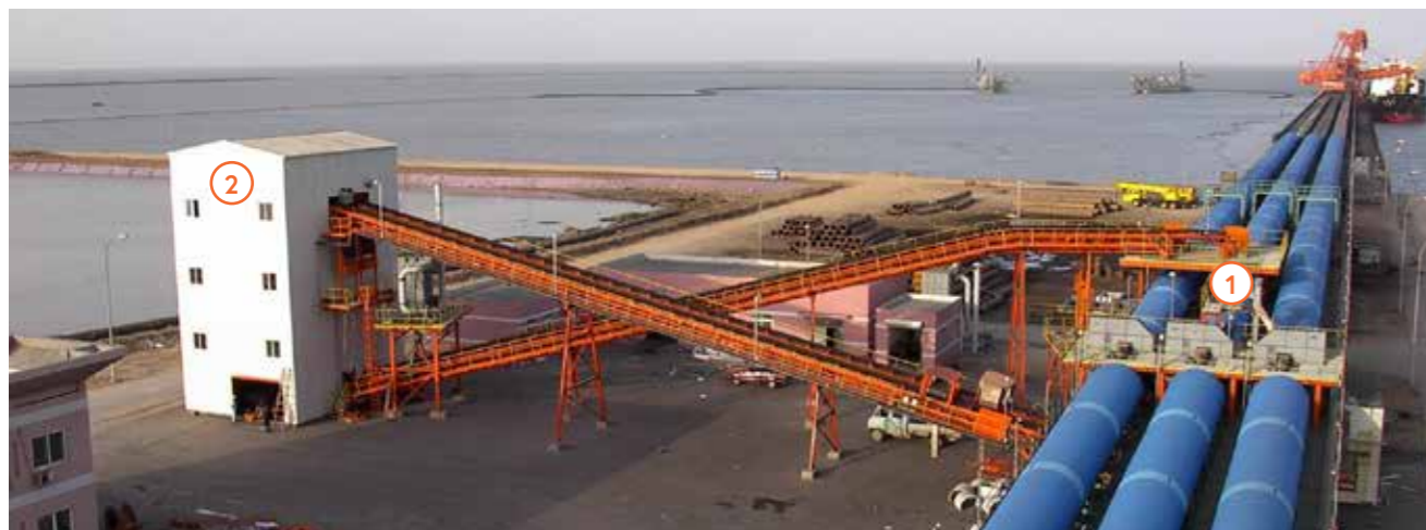
Amostragem (1) e preparação de amostra (2) de carvão durante o carregamento de um navio
