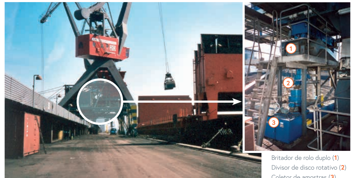
Amostragem de carvão em um guindaste de descarga
