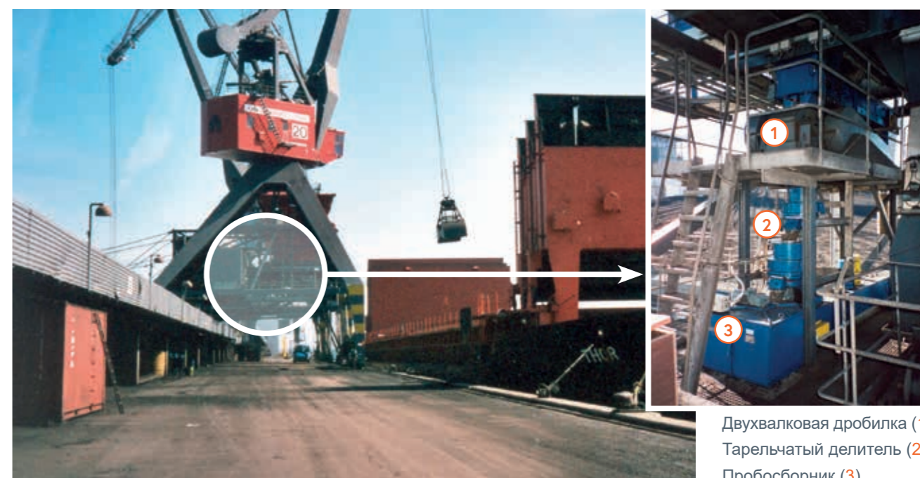
Пробоотбор в кране разгрузки угля
