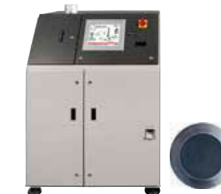
Автоматическая установка измельчения и прессования (3), пресс-таблетка
