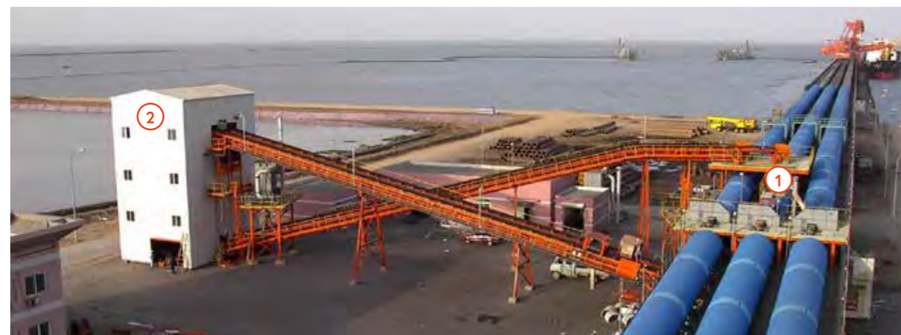
Отбор проб (1) и пробоподготовка (2) угля по время погрузки судна
