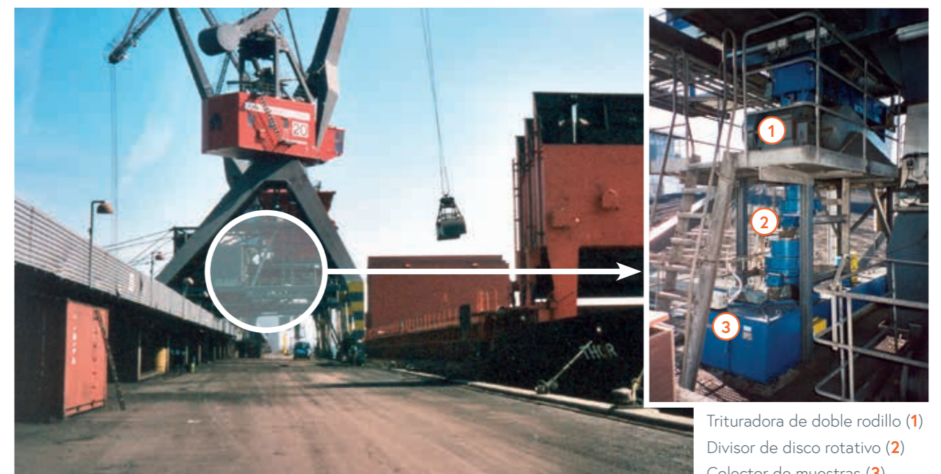
Toma de muestra de carbón en una grúa de descarga
