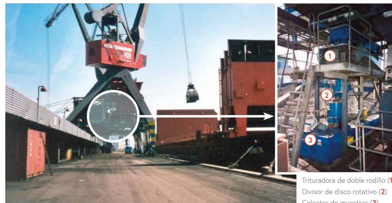
Toma de muestra de carbón en una grúa de descarga
