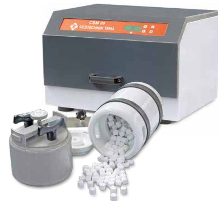
Помольные камеры из стали и керамики с мелющими телами
