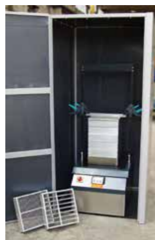
ASM 400 con aislamiento acústico y tamices con barras
