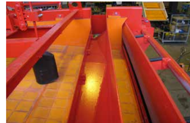
Schwimmer, Leichtgutrinne und Schwergutaustrag
