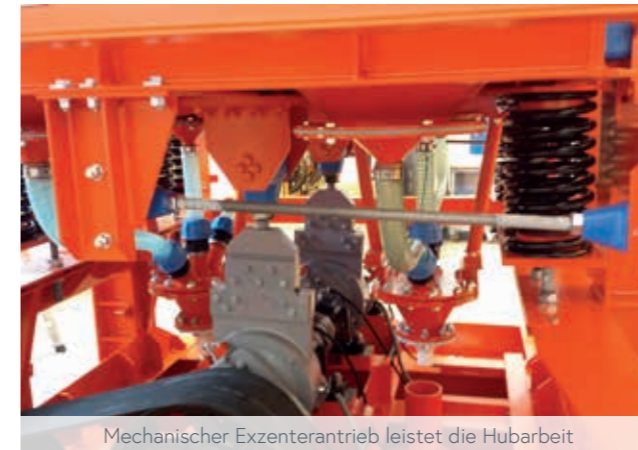
Schwimmer, Leichtgutrinne und Schwergutaustrag
