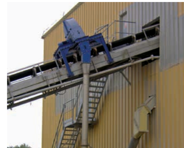
Probenahme von Kalkstein
