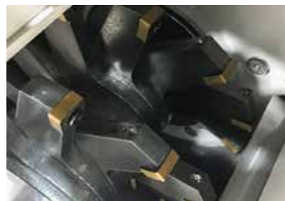
Rotor: Ausführung Schneidmühle
