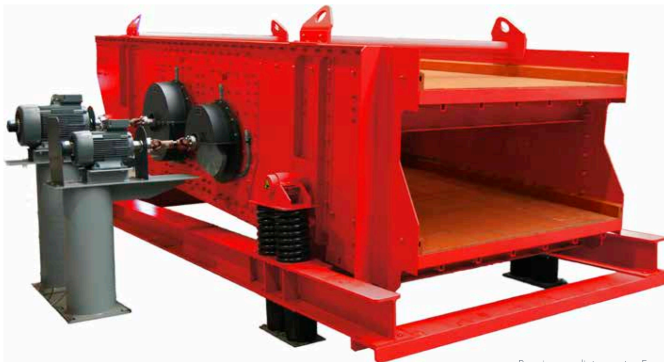
Przesiewacz eliptyczny typ E, sterowany elektronicznie
