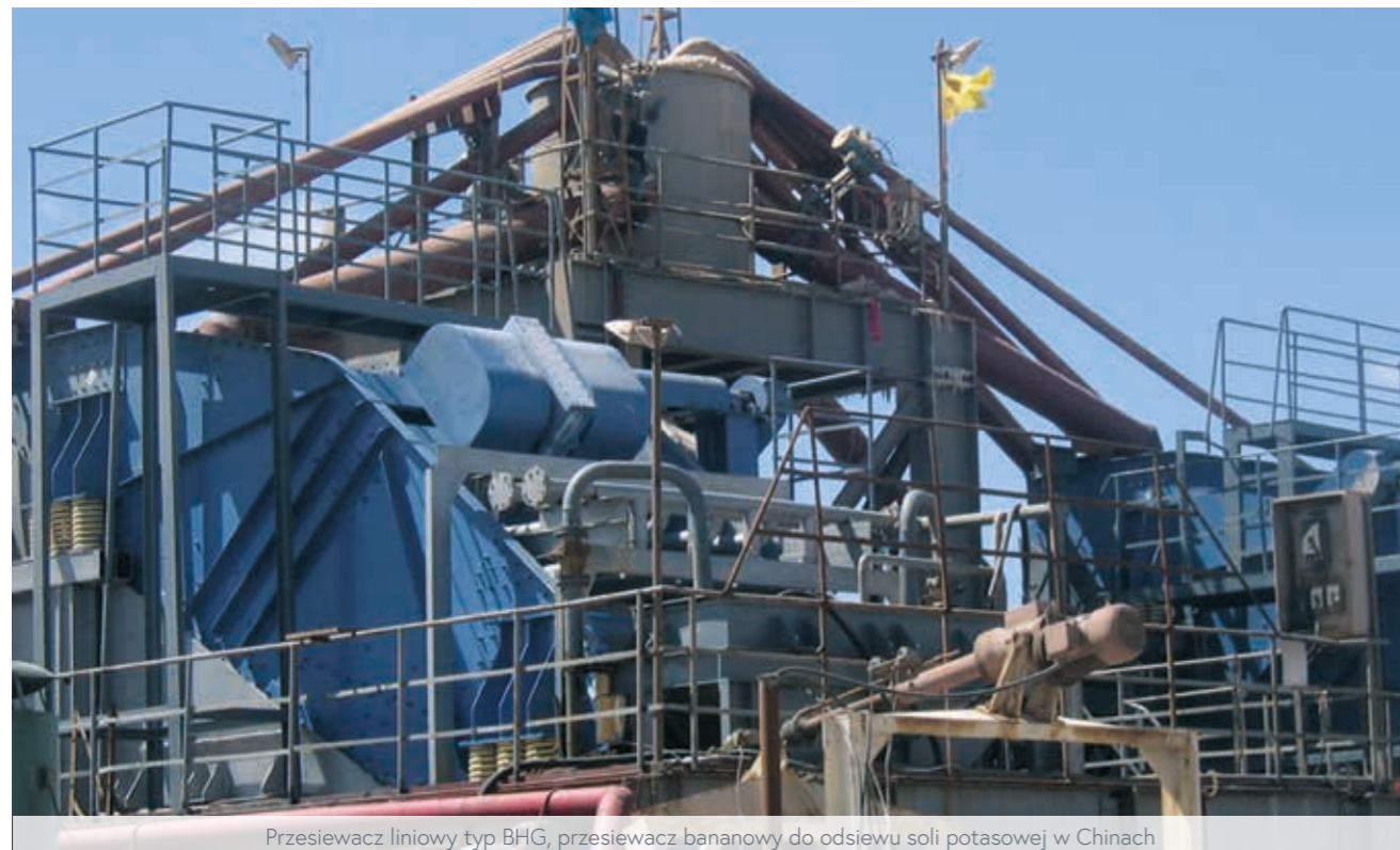
Przesiewacz liniowy typ BHG, przesiewacz bananowy do odsiewu soli potasowej w Chinach
