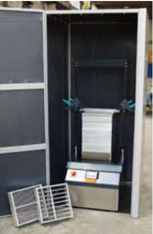
ASM 400 с шумозащитным корпусом и ситовыми ящиками
