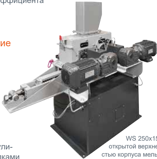
WS 250x150-L с открытой верхней частью корпуса мельницы
